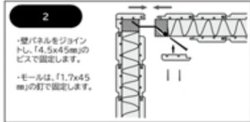
・壁パネルをジョイントし、「4.5x45mm」のビスで固定します。
