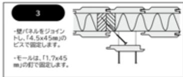
・壁パネルをジョイントし、「4.5x45mm」のビスで固定します。
