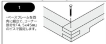
・ベースフレームを四角に組立て、コーナー部分を「4.5x45mm」のビスで固定します。
